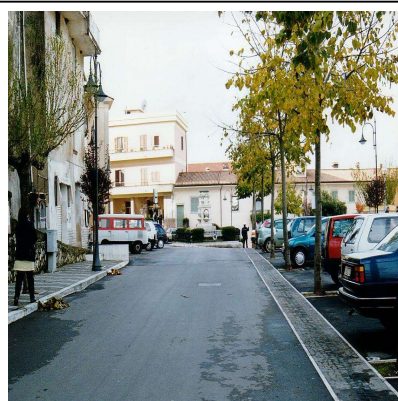
Esempio di area di parcheggio alberato ai margini della carreggiata con stalli perpendicolari.
